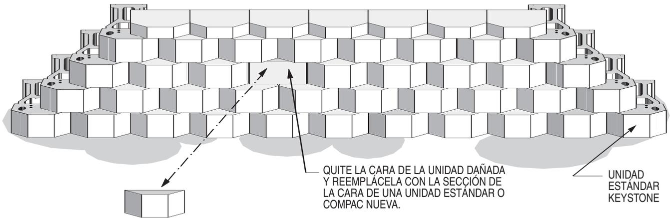
LAS CONEXIÓN POR MEDIO DE PASADORES A LAS HILERAS DE UNIDADES KEYSTONE POR ARRIBA Y POR DEBAJO DE LAS UNIDADES, PERMANECEN INTACTAS CUANDO SE REMUEVEN ELEMENTOS ROTOS O DAÑADOS DE LA SUPERFICIE POR MEDIO DE UN CINCEL NEUMÁTICO
